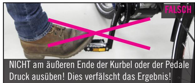
**NICHT** am äußeren Ende der Kurbel oder der Pedale Druck ausüben! Dies verfälscht das Ergebnis!
