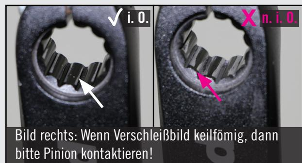
Bild rechts: Wenn Verschleißbild keilförmig, dann bitte Pinion kontaktieren!
